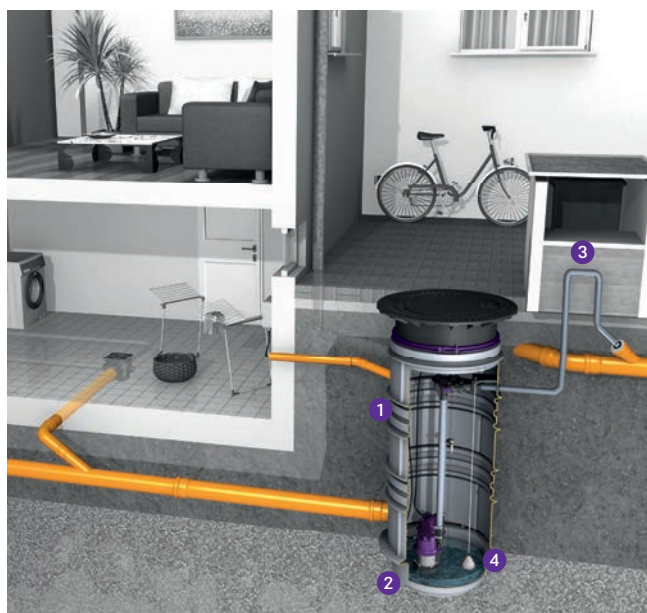
1 Насосная станция 2 Насос 3 Pressure pipe 4 Датчик давления
