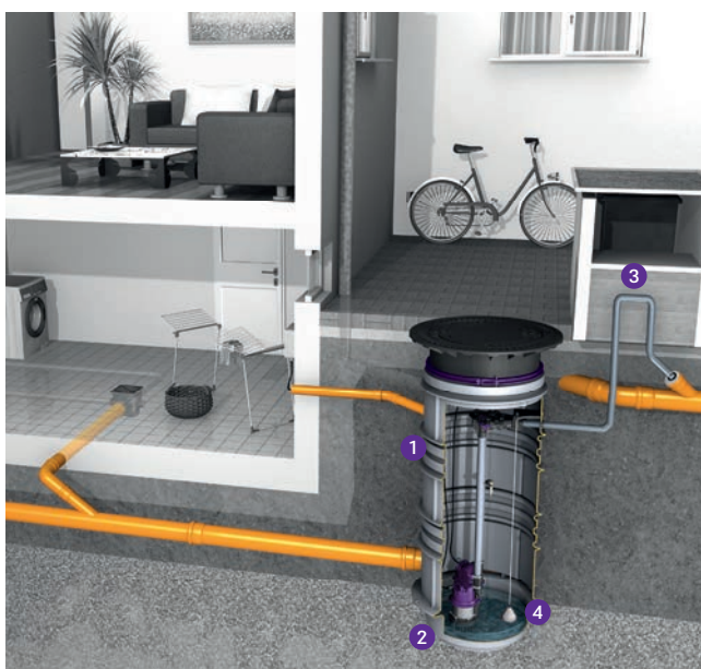
1 Насосная станция 2 Насос 3 Pressure pipe 4 Датчик давления
